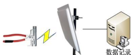
图 7 设备读取标签示意图
